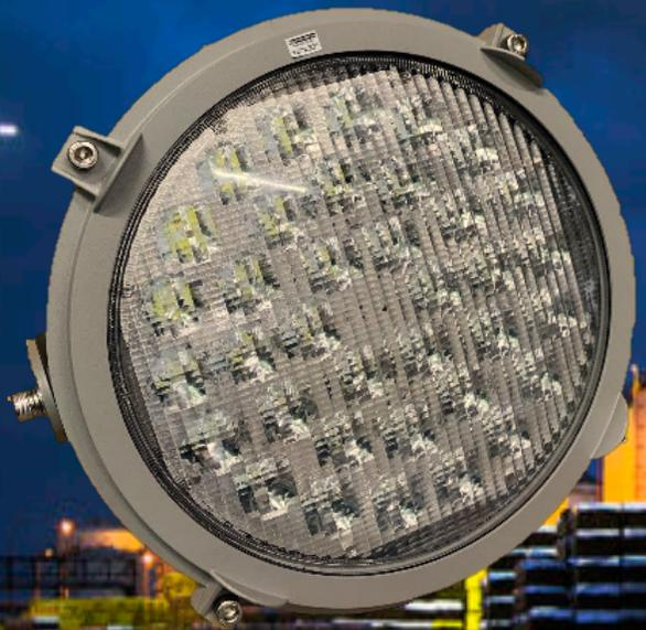
Solljus Stella LED EX è un apparecchio di illuminazione con un focus su durata e qualità molto elevate. Le lenti in vetro brevettata, ha una resistenza eccezionale, abbagliamento minimo e aiuta a ridurre al minimo l'inquinamento luminoso. L'apparecchio Stella LED EX resiste ad ambienti corrosivi, ed è conforme alle norme Atex EX 1,2, 21 e 22. Il modulo LED ed il driver sono facili da sostituire. L'apparecchio è inoltre conforme alle rigide normative EMI (Electro Magnetic Interference).
